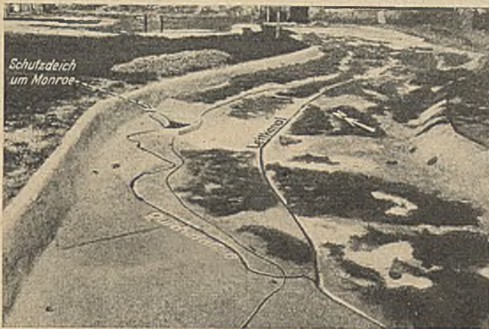
Abb. 4. Modell des Leitkanals für die Hochwasserumleitung durch die Boeuf-Niederung. Die dunklen Flächen sind Buschwald, der aus Moos nachgebildet worden ist. Die hellen Stellen sind Ablagerungen von gelöschtem Kalk.
