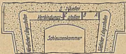
Abb. 2. Kanalschleuse Moll. Dichtung des Verbindungsstollens.
