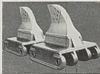
Abb. 8. Reißzähne für Eimerbagger.
