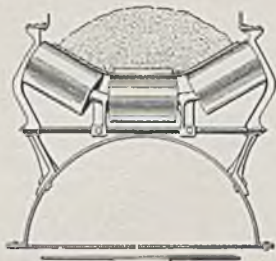
Abb. 11. Muldenförderband auf Hohlrahmen.
