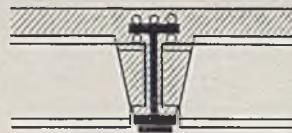
Abb. 8. Anschluß des Längsträgers an den Querträger.
