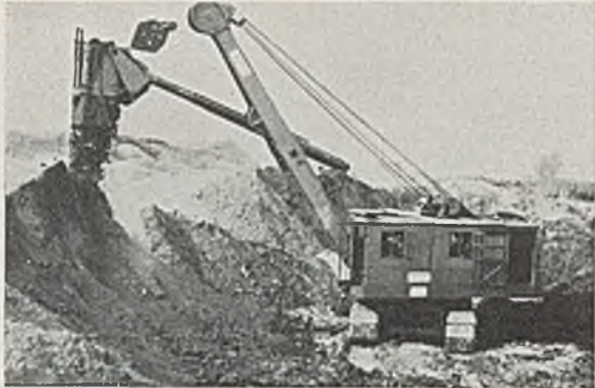
Abb. 7. 1,35-m 3 -Löffelbagger mit Vorschubgetriebe für große Reichweiten und große Hubgeschwindigkeit (IB). Aufnahme: Demag.
