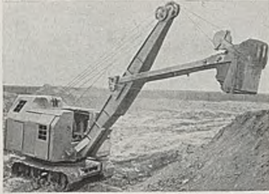
Abb. 12. 0,56-m 3 -Umbau-Löffelbagger. Aufnahme: Eisenwerk Weserhütte AG.
