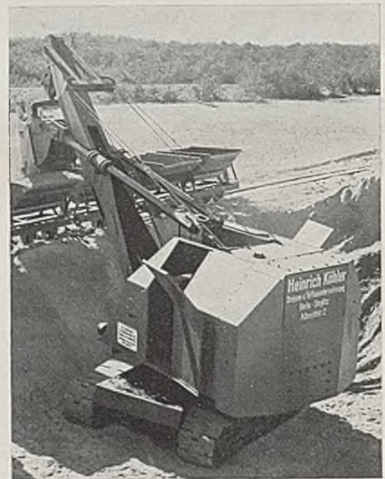
Abb. 6. Löffelbagger mit Seilvorstoßwerk und doppeltem Löffelstiel. Aufnahme: Orenstein & Koppel AG.
