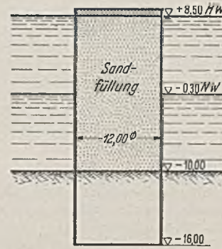
Abb. 5. Sandgefüllter Spundwandhohlzylinder als Dükdalbe.
