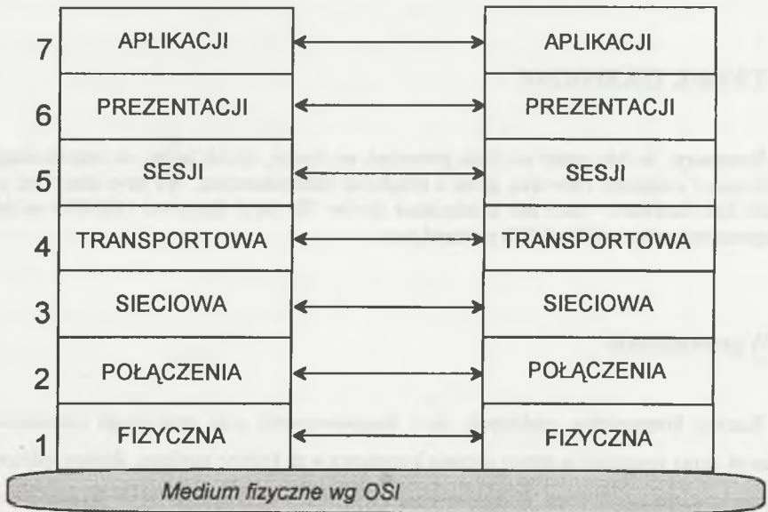
Rys. 1. Warstwy w modelu odniesienia wg OSI
