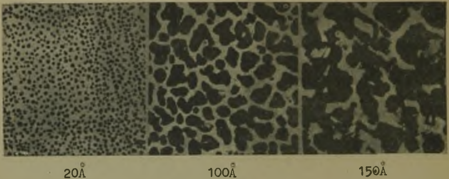
Rys.3. Zdjęcie pod mikroskopem elektronowym warstw złota grubości 20 Å, 100 Å, 150 Å, otrzymanych po 2 sek. odparowania. Powiększenie 75000 x (5)
