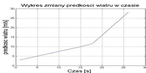
Rys. 4. Wykres zmiany prędkości wiatru przy ustawieniu kąta łopaty 3,5 [deg]
