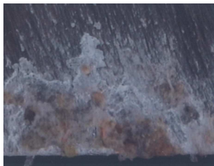
Rys. 2. Wybrane zdjęcia defektów pojawiających się na nożu gilotyny: a) odłamanie niewielkiego kawałka materiału z ostrza noża, b) narost na nożu
