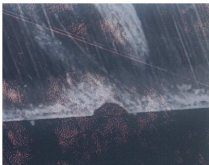
Rys. 2. Wybrane zdjęcia defektów pojawiających się na nożu gilotyny: a) odłamanie niewielkiego kawałka materiału z ostrza noża, b) narost na nożu
