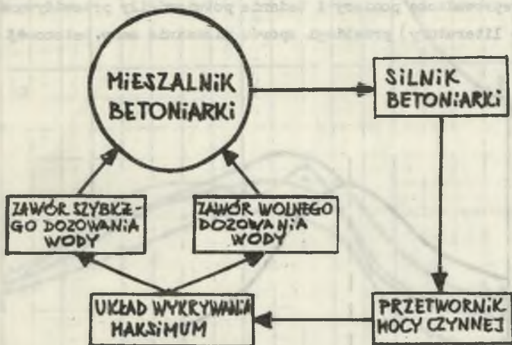
Rys. 6. Schemat blokowy układu automatycznego sterowania konsystencji masy betonowej
