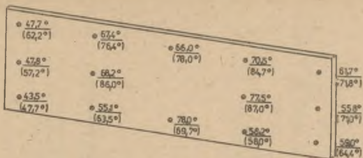
Rys. 7. Rozkład temperatur w warstwie fakturowej
