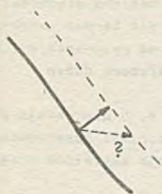
Rys. 2. Obserwacja przemieszczenia konturu nie dostarcza informacji o składowej ruchu wzdłuż konturu
