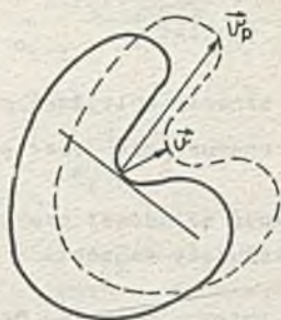
Rys. 12. Długość składowej prostopadłej wektora prędkości nie może być wyznaczona przez pomiar długości wektora \vec{v}^p
