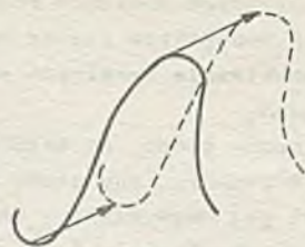
Rys. 4. Jeśli krzywa posiada charakterystyczne punkty, które mogą zostać odszukane na obrazie przesuniętym, to wektor prędkości w tych punktach może zostać odtworzony
