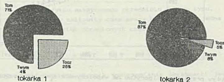
Rys. 4. Udział składników czasowych w skali jednej zmiany, T_{cm1} = 160 s; T_{cm2} = 260 s
