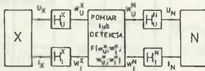
Rys.2. Ogólny schemat strukturalny układów do pomiaru immitancji
