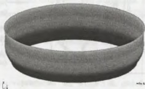
Rys. 3. Deformacja powłoki ciągłej od obciążenia temperaturą
