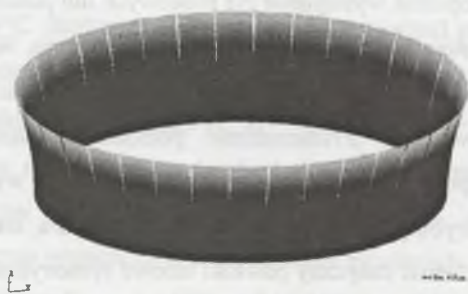
Rys. 4. Deformacja układu płyt od obciążenia temperaturą
