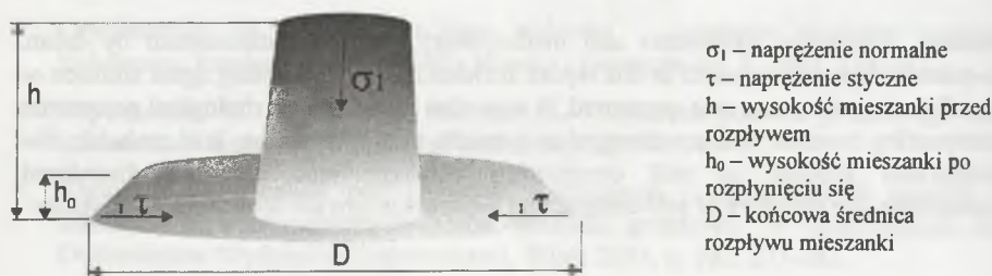
Rys. 1. Schemat rozplywania się mieszanki samozagęszczalnej [4]
