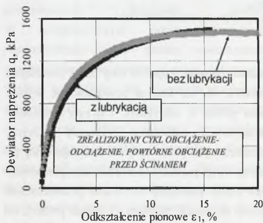
Rys. 5. Porównanie wytrzymałości maksymalnej odniesionej do warunków z odpływem z zastosowaniem lubrykacji i bez niej
