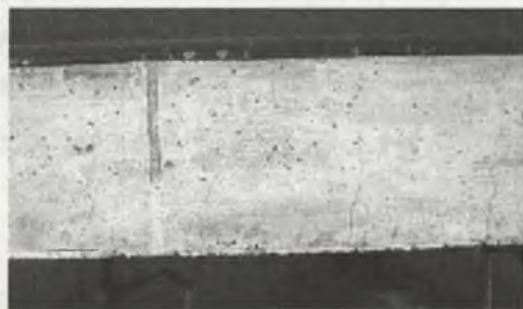
Rys. 2. Rozwój zarysowania dla przyjętych stopni uszkodzenia belki: a) stopień uszkodzenia D2, b) stopień uszkodzenia D4
