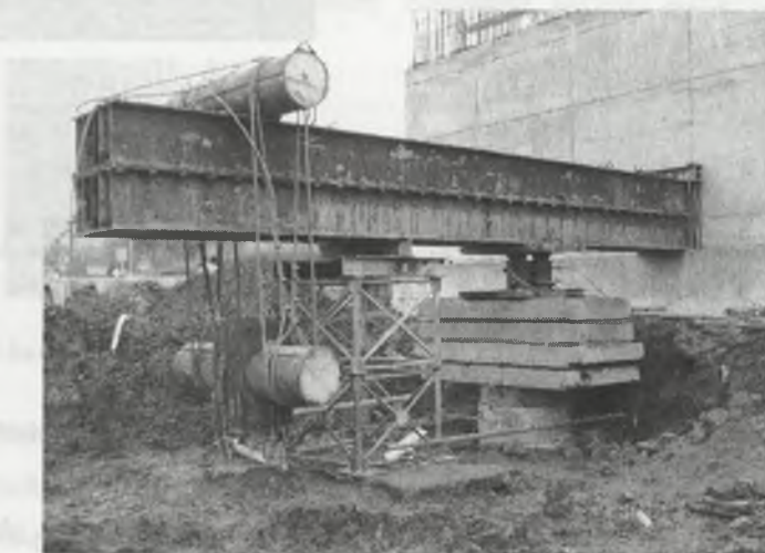
Rys. 3. Widok stanowiska do próbnych obciążeń kolumny kamiennej
