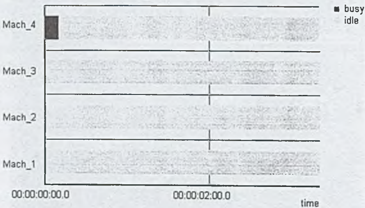
Rys.8. Wykres Gantta. Powstanie blokady w systemie (por. rys. 4)
