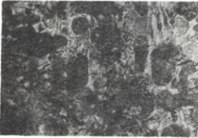
Rys.11 Struktura próbki 146 A nie obrabionej cieplnie /środek/. Perlit, ledeburyt, grafit
