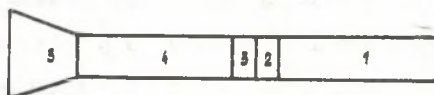
Rys.2. Schemat pobierania próbek z odlewów kokilowych: 1 - próbka wytrzymałościowa; 2 - próbka do pomiaru twardości po obróbce cieplnej i na zgląd; 3 - próbka na zgląd i HB przed obróbką cieplną; 4 - zapasowa próbka wytrzymałościowa; 5-układ wlewowy
