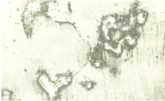
Rys. 18. Staliwo wysokomanganowe niemodyfikowane po przesyca- niu w temp. 950°C w czasie 30 min. Na granicach ziarn austeni- tu wydzielenia węglików. Wytop B1. Traw. w \text{FeCO}_3 . Pow 500x
