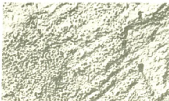
Rys. 26. Staliwo wysokomanganowe modyfikowane 0,15% po odlaniu. Ziarno austenitu, trawiono \text{FeCl}_3 . Pow. 30 000x.
