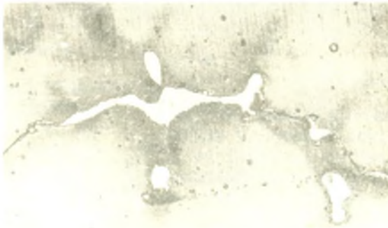
Rys. 20. Staliwo wysokomanganowe z dodatkiem 0,15% Sb + 0,15% P. Wytop C. Austenit, na granicach ziarn wydzielenia eutekty- ki fosforowej. Trawiono 3% nitałem. Pow. 500x.
