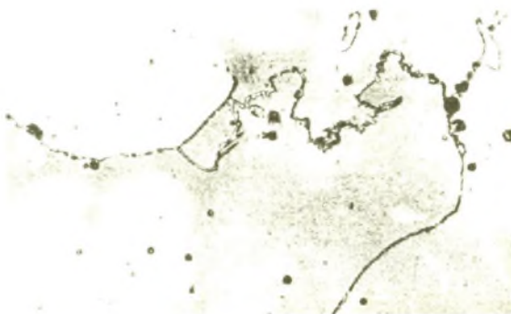
Rys. 16. Stalwo wysokomanganowe modyfikowane 0,10% Sb. Austenit, węglki na granicach ziarn. Wytop B3. Traw. 3% nitałem, pow. 500x
