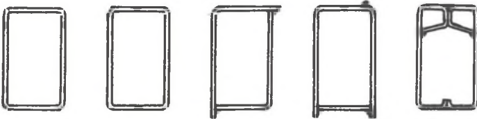
Rys. 1. Przekroje skrzynekowe z blach giętych
