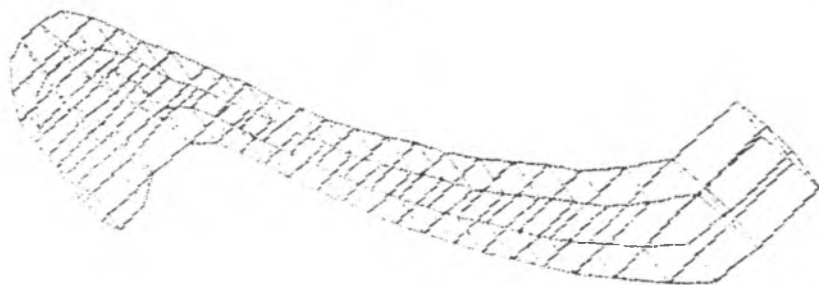
Rys.1. Model symetrycznej części warstwy poprzecznej kształtownika Fig.1. Model of the transverse layer symmetrical part of the section
