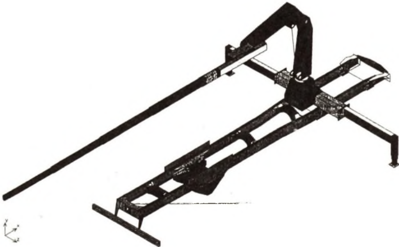
Bild 5. Berechnungsschemen für Autokran
