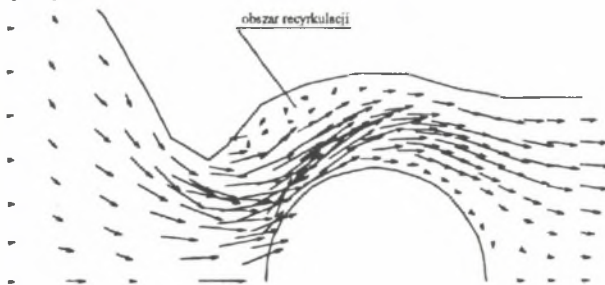
Rys. 11. Pole prędkości z występującym obszarem oderwania i recyrkulacji dla położenia kulki x/D=0.5
