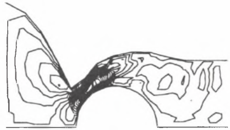
Rys. 6. Izolinie prędkości w kierunku osi r Fig. 6. Radial velocity component isolines
