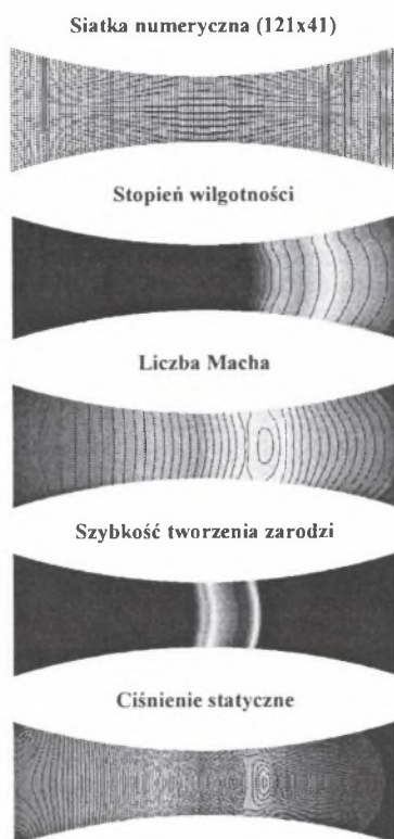
Rys.1. Rozkłady parametrów w dyszy dla przepływu pary wodnej z kondensacją homogeniczną Fig. 1. Parameters distribution in the nozzle for steam water homogenous condensing flow
