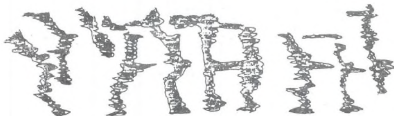
Rys. 4. Obraz zużycia falistego utworzonego na powierzchni toczonej koła wagonu osobowego EW IIB 2378 (Rhätische Bahn): skala 1:1, wysokość wzniesień - 0,04 mm (ciemniejsze obszary), przebieg - 52000 km
