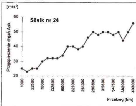
Rys. 1. Przebieg skutecznej wartości przyspieszeń drgań na wysokości ZZ tłoka
