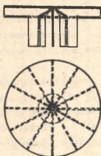
Rys. 2. Mieszadło turbino- nowo z dodatkowymi łopatkami u dołu (stosowane w akceleratorach jako "wirnik - mieszadło")
