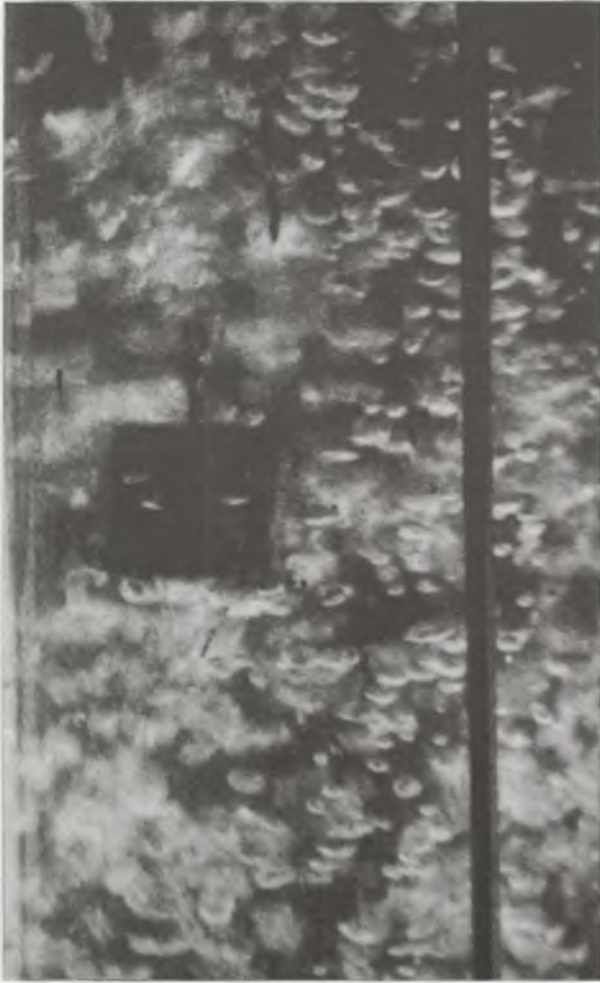
Rys. 44. Opływ prostopadłościanu przez mieszaninę wodno-powietrzną Fig. 44. Flow around a rectangular prism by water-air mixture
