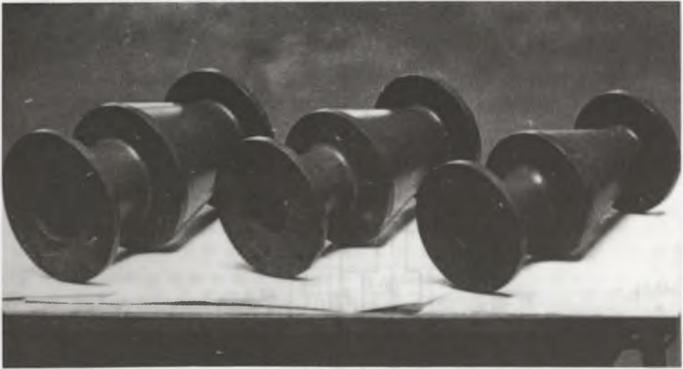
Rys. 35. Widok mieszalników o różnych średnicach wewnętrznych Fig. 35. Mixers with different inner diameters
