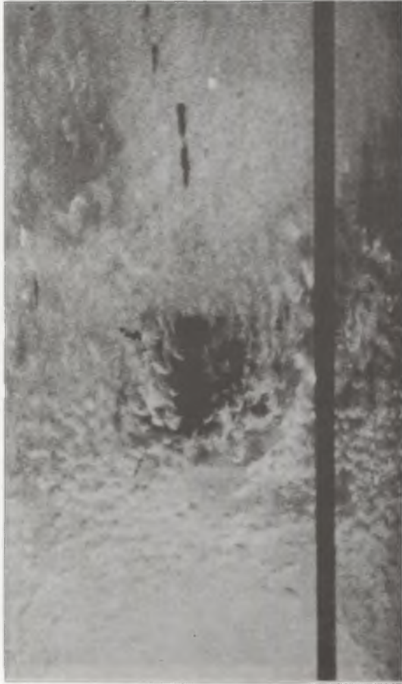
Rys. 43. Optyw kuli przez mieszaninę wodno-powietrzną przy Q_p > 10 \text{ dm}^3/\text{h} Fig. 43. Flow around a sphere by water-air mixture with Q_p > 10 \text{ dm}^3/\text{h}
