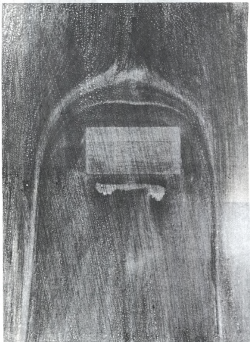
Rys. 1. Obraz wizualizacji opływu pojedynczego budynku; metoda olejowa Fig. 1. A picture of flow around visualisation for a detached building - an oil technique
