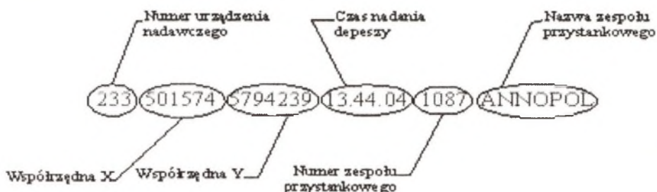
Rys. 2. Przykład depechy z pozycją tramwaju Fig. 2. An example of tramway's position wire
