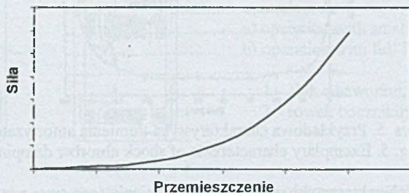
Rys.3. Zmiana sztywności sprężyny stożkowej Fig. 3. Characteristic of cone spring rate
