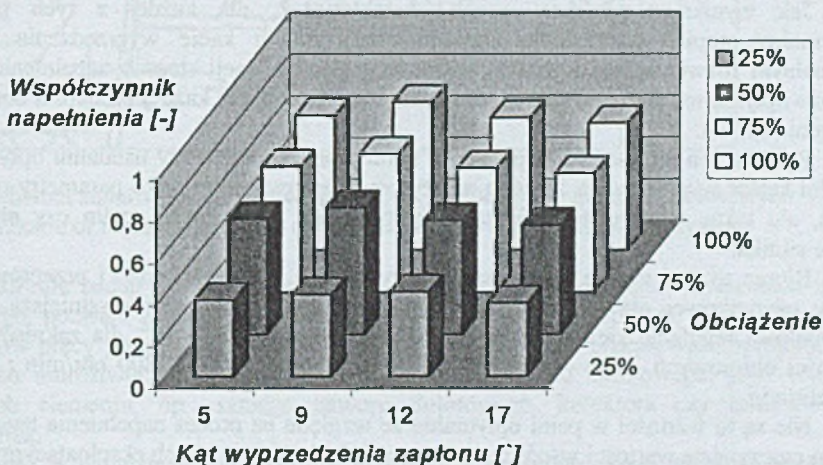
Rys.3. Charakterystyka współczynników napełnienia dla prędkości obrotowej silnika n=1500 obr/min
