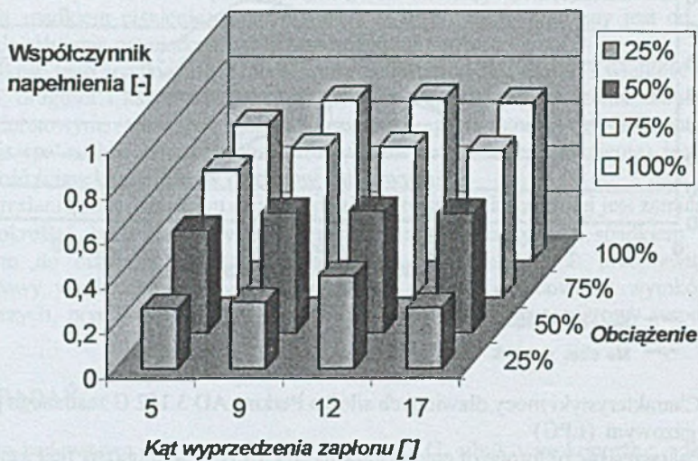
Rys.4. Charakterystyka współczynników napełniania dla prędkości obrotowej silnika n=1900 obr/min
