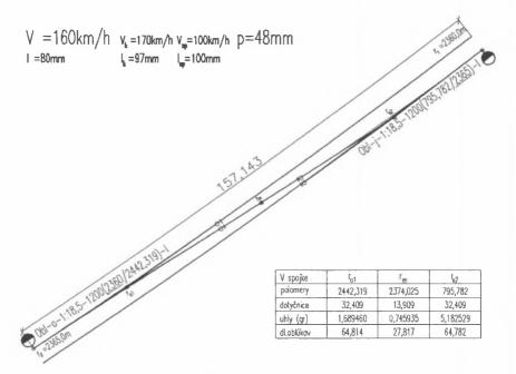
Fig. 2. The cross-over between curved tracks running in the opposite direction Rys. 2. Połączenie torowe pomiędzy zakrzywionymi torami biegnącymi w przeciwnym kierunku
