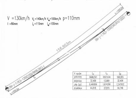
Fig. 1. The cross-over between curved tracks running in the same direction Rys. 1. Połączenie torowe pomiędzy zakrzywionymi torami biegnącymi w tym samym kierunku
