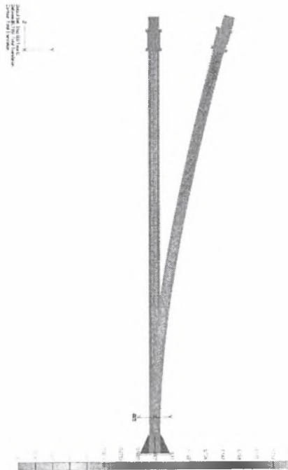
Rys. 10. Maksymalne odkształcenie masztu sygnalizatora w kierunku działania siły (widok z boku skala 1:10)
