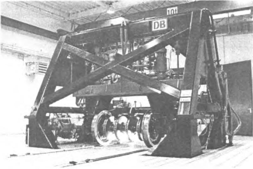
Fig.4. Wheel set roller test rig (DB AG) in Kirchmöser
