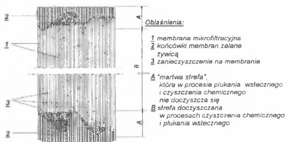
Rys. 2. Rozkład zanieczyszczeń w module membranowym
