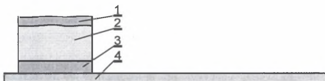
Rys. 1. Test do pełnej krwi: 1) błona półprzepuszczalna separująca erytrocyty i przy okazji inne upostaciowione składniki krwi, 2) warstwa reakcyjna np. bibuła nasycona zestawem odczynników, 3) warstwa łącząca, 4) nośnik
