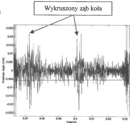
Rys. 4. Sygnał drganiowy: a) zarejestrowany podczas pomiarów; po dekompozycji i rekonstrukcji detali: b) pr. = 6, c) pr. = 7, d) pr. = 8
