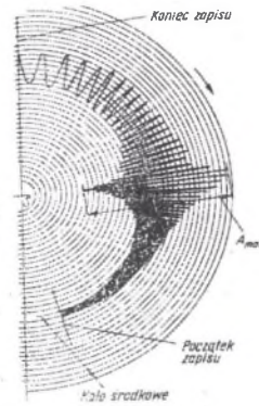
Rys. 2. Przykładowy wynik badań amortyzatora na urządzeniu BOGE
