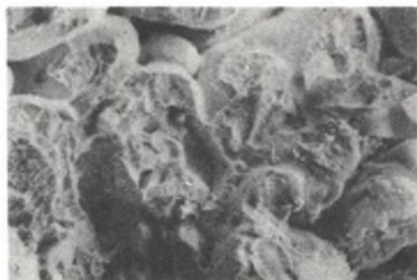
Rys. 23. Staliwo modyfikowane manganem (wytóp D) N.950^{\circ}\text{C}/1\text{h} i 0.650^{\circ}\text{C}/3\text{h} , U_{-196} \approx 1,2 \text{ kGm/cm}^2 . Przełom transkryystaliczny żupliwy ze śladami pęknięć ciągliwych i międzykryystalicznych, 200x
