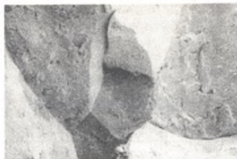
Rys. 19. Staliwo niemodyfikowane (wytop A), N 950°C/1h i 0.650°C/3h, U_{196} \approx 1 kGm/cm 2 . Typowy przełom transkryystaliczny łupliwy bez śladów odkształcenia plastycznego powierzchni, 70x
