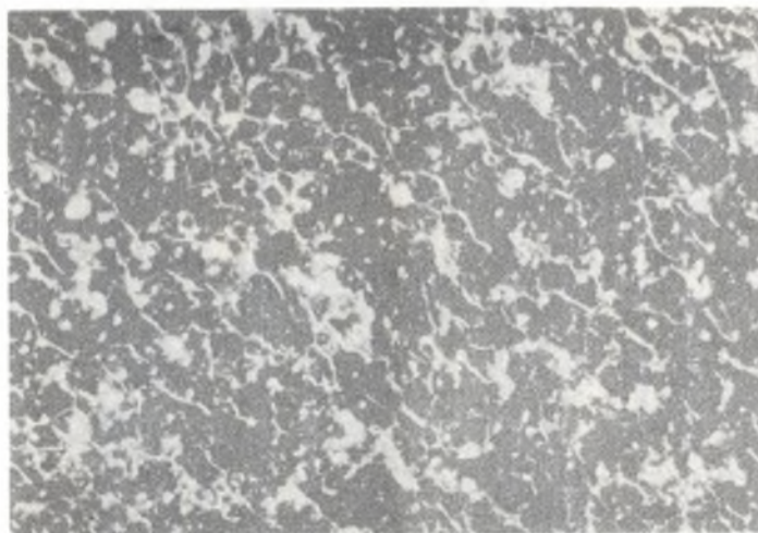
Rys. 14. Szczegół struktury jak na rys. 13 obserwowany przy temperaturze 950°C po 15 min.; 250x
