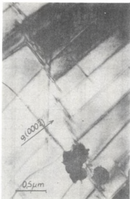
Rys. 11. Układ błędów ułożenia oraz dyslokacji w kryształach ZnO
