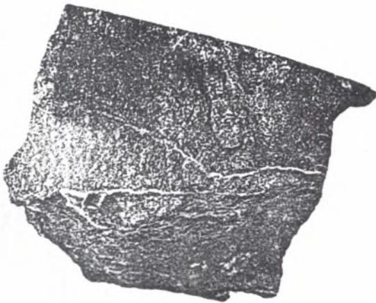
Fot.1. Diabaz afanitowy. Ilustracja makrostruktury Mikroszczeliny zabliznione kalcytem. Wielkość naturalna
