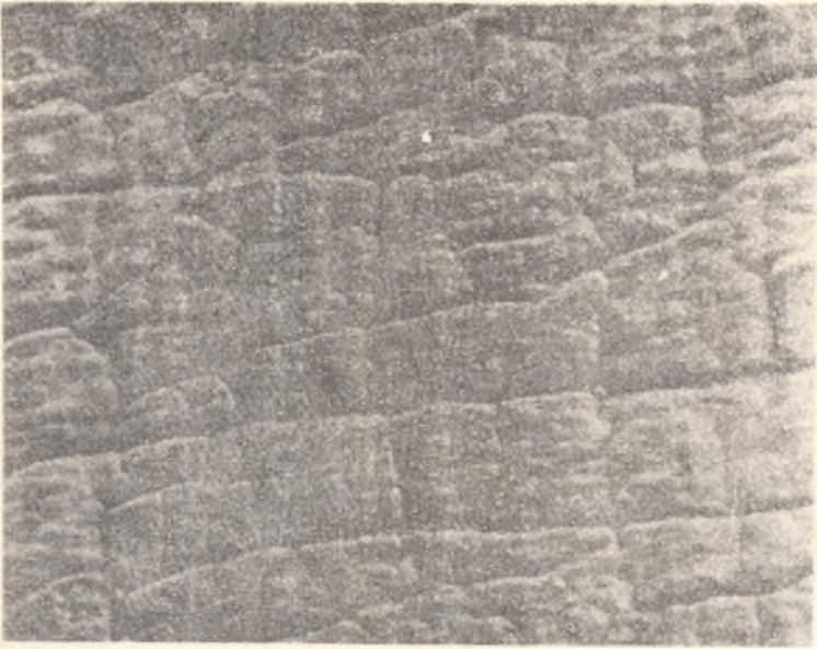
Rys. 9. Powierzchnia próbek po 60 cyklach: a) cieplnych 10 700°C
