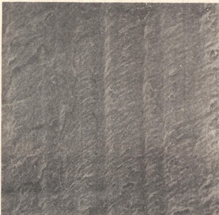
Rys. 7. Powierzchnia próbki po 10 cyklach cieplno-mechanicznych (cykl 10 700°C, E = 0,57 J ) Powiększenie 200 x
