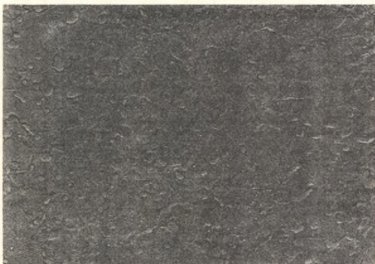
b) po zmęczeniu cieplnym N = 200 cykli, 10 \quad 700^{\circ}\text{C} Mikroskop elektronowy, replika tرافیолowa. Powiększenie 5000x
