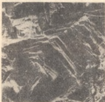
Rys. 3. Struktura przełomu próbki w stanie wyjściowym. Mikroskop skaningowy, pow. 100 x
