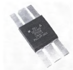
Rys. 3. a) Schemat ideowy falownika klasy DE z drajwerem sinusoidalnym; b) drajwer DEIC420 Fig. 3. a) Schematic diagram of the Class DE inverter with sinusoidal gate driver; b) driver DEIC420
