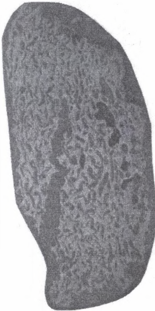
Fot.9. Inertynit o budowie łukowej w prawej części przechodzący w koronkę. Powięk- szenie 250X. Próbką żużla. K - 7 Photo.9. Inertinite with structure turning into lacy form (right). 250X magnification. Slag sample. Boiler K - 7
