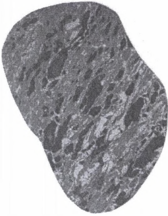
Fot. 7. Plaster miodu z fragmentami inertynitów. Powiększenie 250X. Próbką żużla. K - 6 Photo 7. Honey comb with inertinite fragments. 250X magnification. Slag sample. Boiler K - 6
