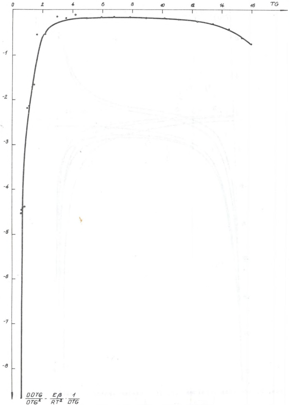
Rys. 3. Rozkład stałego płytkowego źródła domieszek fosforu kontrolowany przez dyfuzję produktów poprzez warstwę produktu stałego
